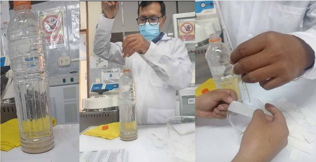
Figura 3 Proceso de separación por densimetría en laboratorio
